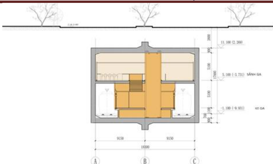
Hình 40. Mặt cắt ngang ga Hoàng Đạo Thúy (S5)
