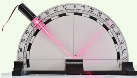
Hình 13.6. Thí nghiệm phản xạ ánh sáng
